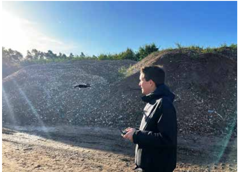
Projektleiter Marius Lentzko lässt die Drohne steigen, um ein Haufwerk zu vermessen
