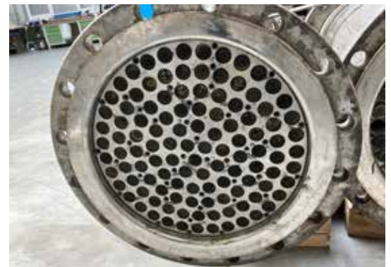
Rückkehr nach 23 Jahren: Vier dieser Module mit keramischen Membranen von atech wurden gewartet und die Membranen ausgetauscht
